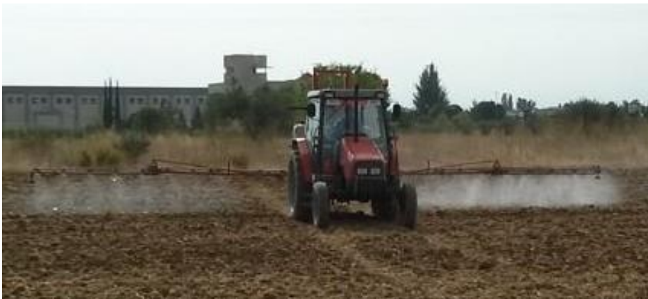
Figura 2. Polvorització generada per un broquet convencional (esquerra imatge) i broquet antideriva (dreta de la imatge)
