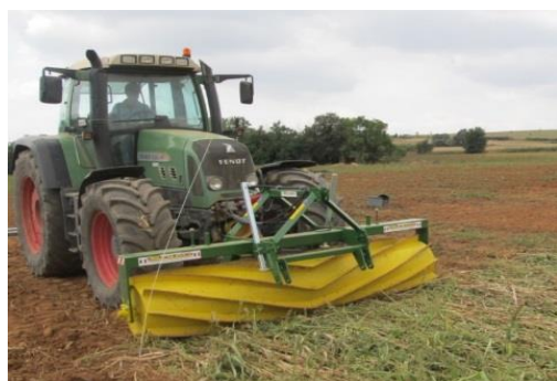
El roller crimper (RC) tomba i aixafa el cultiu de cobertura
