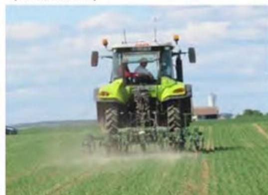
Binage mécanique sur céréale avec un autoguidage RTK (Boigneville 2013)
