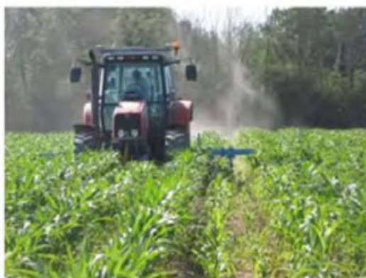
Binage mécanique sur maïs semence avec un autoguidage RTK (2011)
