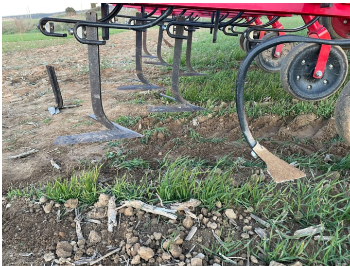
Figura 2. Al davant (dreta de la imatge) es pot observar una rella de forma triangular. Les que tenen forma de làmina (darrera i esquerra de la imatge) són les més indicades pels treballs més superficials.
