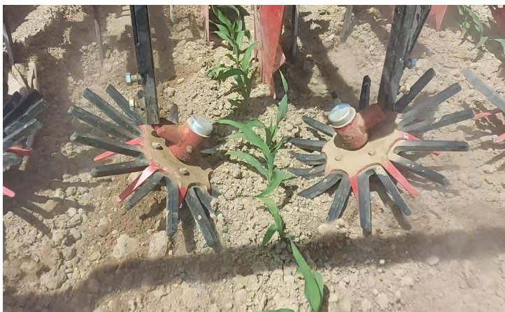
Figura 3. Les rodes de dits o 'fingers' ajuden a controlar l'herba que està en les files del blat de moro.
