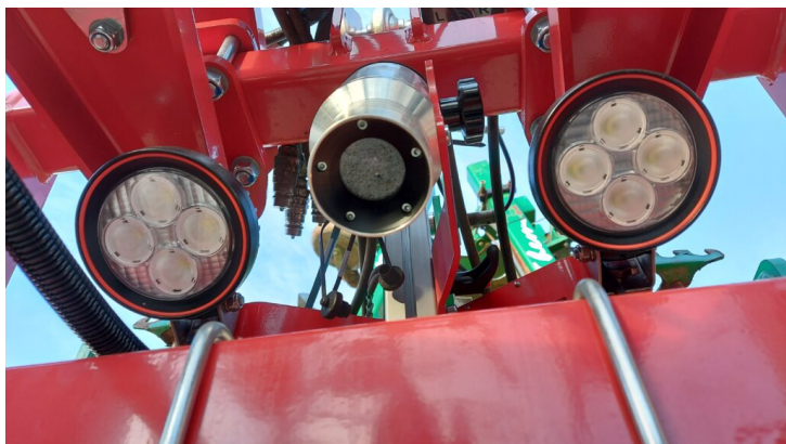
Figura 5. Càmera d'una binadora de precisió. Als costats, dos llums per millorar la lectura.
