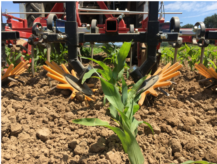
Figura 3. Detall dels dits flexibles d'una binadora
