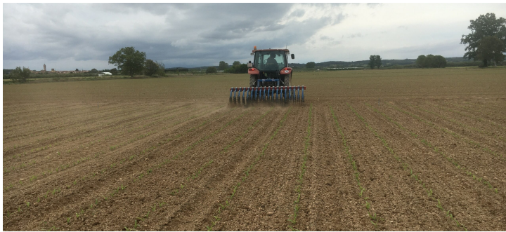
Figura 2. Desherbatge amb el rascler rotatiu d'estrelles
