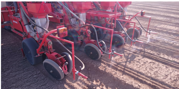
Figura 4. Aplicació d'herbicida a bandes durant la sembra
