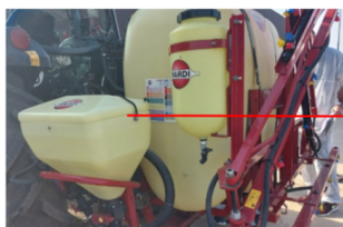
Dipòsit incorporador de fitosanitaris al polvoritzador
