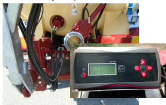
Figura 7. Equip conductímetre fix a la cisterna
