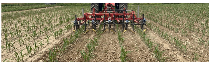
Figura 5. Passada de la binadora de precisió a la parcel·la.
