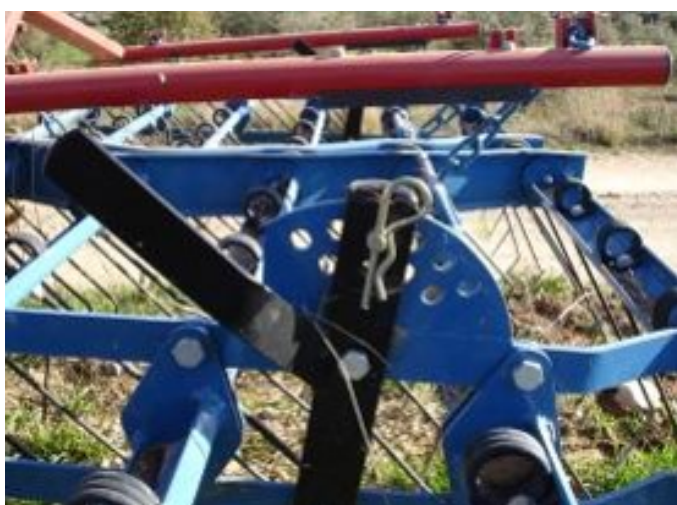
Imatges 1 i 2: Detall dels elements de regulació de la rascla de pues com són l'angle d'incidència de les varetes flexibles o la pressió sobre el sòl per mitjà de les rodes.
