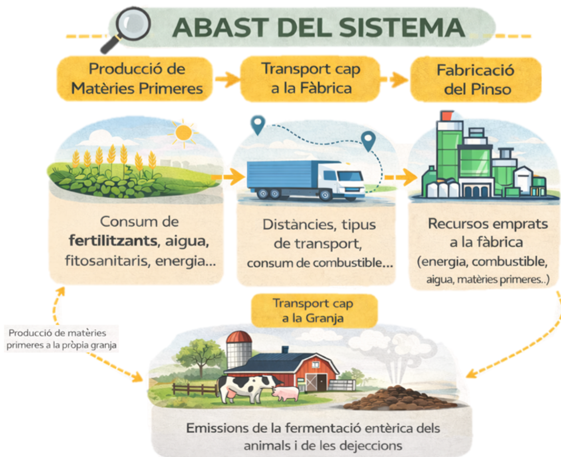
Figura 1. Principals baules de la cadena i exemple de dades a considerar per quantificar l'impacte ambiental de la producció d'un pinso mitjançant l'Anàlisi de Cicle de Vida (ACV).
