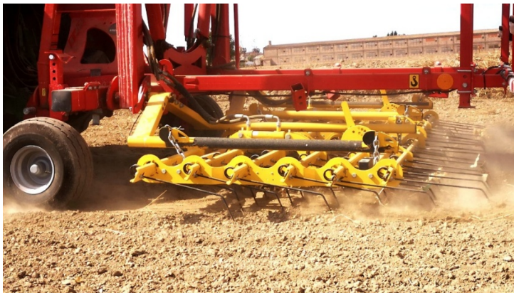
Figura 2. Grada de pues flexible en sembra en sec abans de la inundació. Control mecànic primerenc per induir avantatge competitiu del cultiu.
