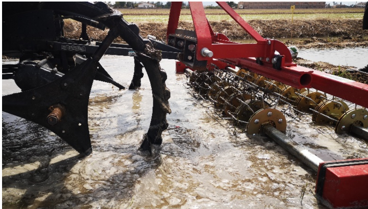
Figura 3. Grada de rodet utilitzada per al control mecànic de males herbes en sistema de sembra per inundació. El rodet actua sobre la primera cohort emergida sota làmina d' aigua, reduint la pressió inicial de gramínies.
