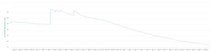
Imatge 5. Detall del contingut volumètric (%) d'aigua al sòl que mesura la sonda de 20cm instal·lada en una parcel·la de la Tallada d'Empordà.
