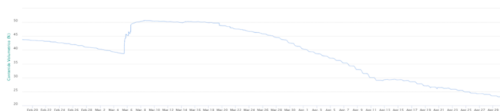
Imatge 6. Detall del contingut volumètric (%) d'aigua al sòl que mesura la sonda de 20cm instal·lada en una parcel·la de la Taradell.
