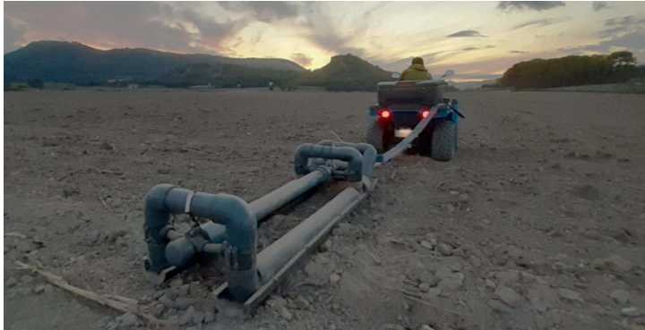
Figura 2. Sensor d'inducció electromagnètica utilitzat en l'elaboració de mapes de sòl, en plena operació, muntat en un trineu i desplaçat per un camp utilitzant un quad.
