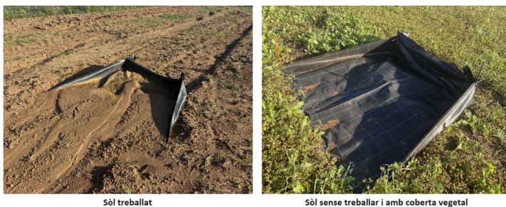
Figura 4. Trampes de sediment després de la segona tempesta: a l'esquerra, a la zona treballada, plena de sediment; a la dreta, a la zona sense treballar, pràcticament buida (Torre Marimon a Caldes de Montbui (Vallès Oriental), 27 d'octubre de 2026)
