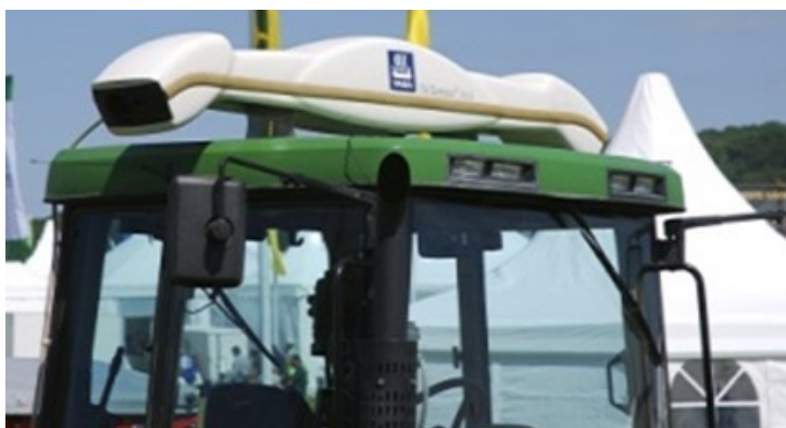
Figura 3. Exemple del sensor òptic N-sensor (Yara) instal·lat en un tractor per mesurar, des del
