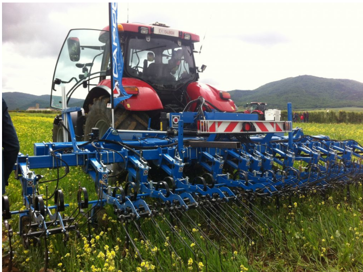
Binadora amb guiatge de precisió pel control de males herbes en cereal d'hivern
