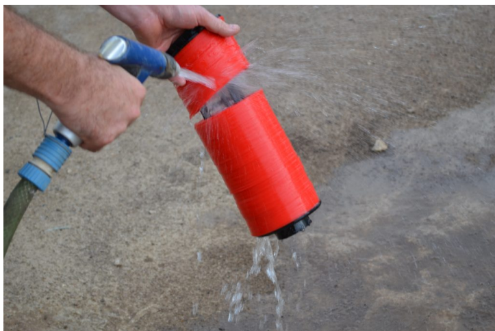
Fotografia 2. Neteja manual d'un filtre d'anelles amb aigua a pressió.
