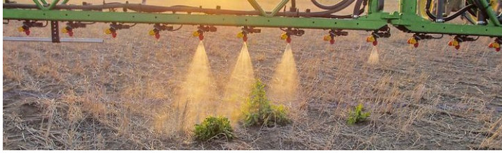
IMATGE 1 Detall de broquets accionats individualment quan el sensor detecta verd. Imatge obtinguda d'internet al web d'Amazone.
