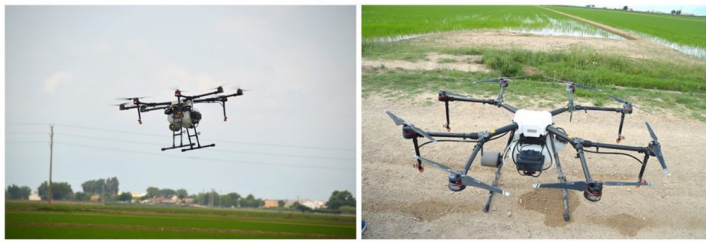
Figura 3. Ús del dron per l'aplicació de productes fitosanitaris als camps d'arròs del Delta de l'Ebre.
