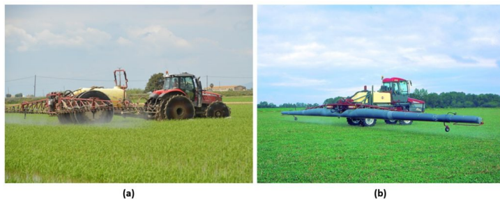
Figura 2. Polvoritzadors per l'aplicació de productes fitosanitaris en cultius extensius. (a) Polvoritzador hidràulic convencional; (b) Polvoritzador hidràulic amb assistència d'aire.
