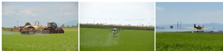
Figura 1. Aplicació a l'arròs amb el polvoritzador hidràulic, el dron i l'avioneta
