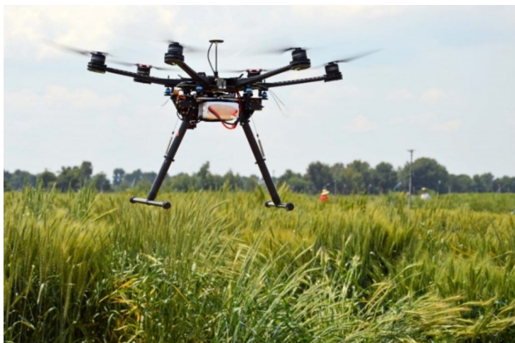
Figura 4. Dron amb càmera per a detectar NDVI en camp
