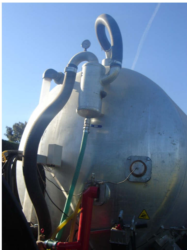
Figura 1. Conductímetre instal·lat en la cisterna de purí, a mitja alçada. (Font: Oficina de
