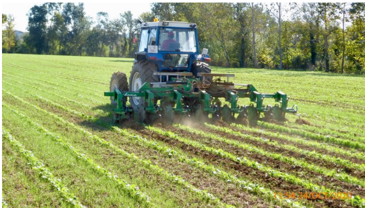
Figura 3. Binadora desherbant en un camp de colza sembrada a 75 cm.
