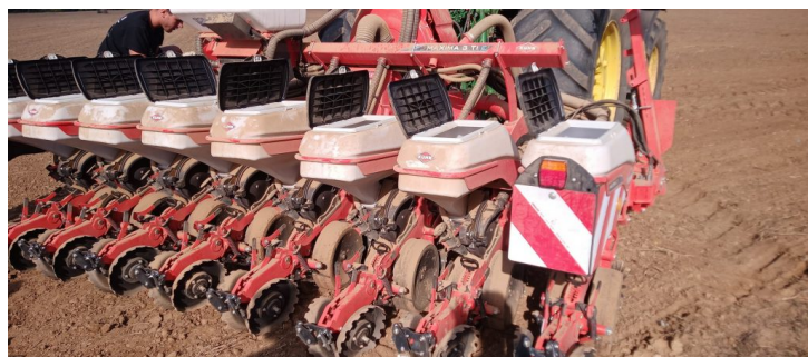
Figura 1. Sembradora monogrà amb els cossos de sembra separats 37,5 cm per sembrar un camp de colza.
