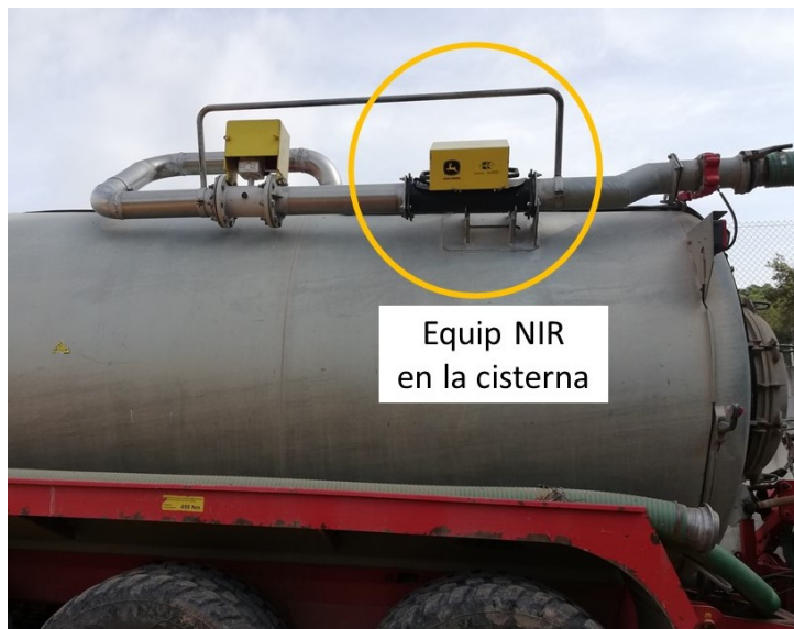
Figura 2.- Equip NIR instal·lat en una cisterna d'aplicació de purins. (autor: Joan Parera)
