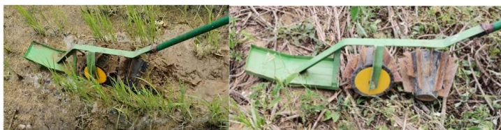
Figura 2. Eina desenvolupada per al desherbatge mecànic en el cultiu d'arròs amb reg per inundació. (Foto: Grup de recerca d'Enginyeria i gestió del reg, UdG).
