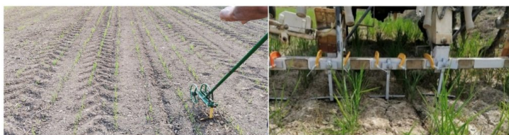
Figura 3. Eina desenvolupada per al desherbatge mecànic en el cultiu d'arròs amb reg per degoteig enterrat. (Foto: Grup de recerca d'enginyeria i gestió del reg, UdG).
