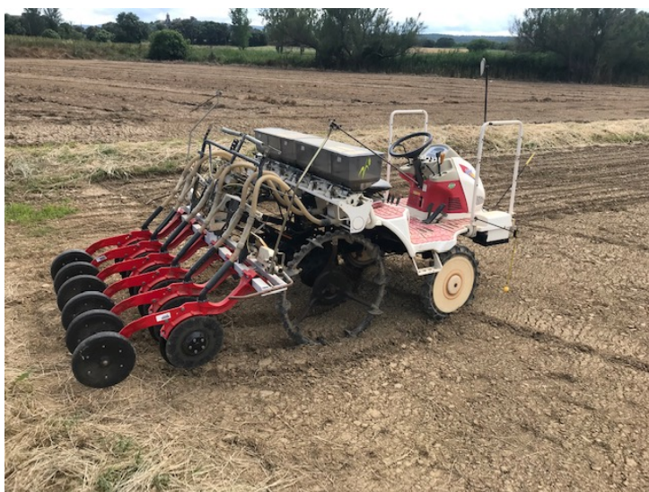
Figura 1. Sembradora adaptada per a sembrar a l'arròs a fileres. (Foto: Grup de recerca d'enginyeria i gestió del reg, UdG).
