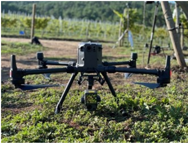
Figura 2. Dron utilitzant en el projecte FlexiGroBots per detectar malalties fúngiques en el cultiu.
