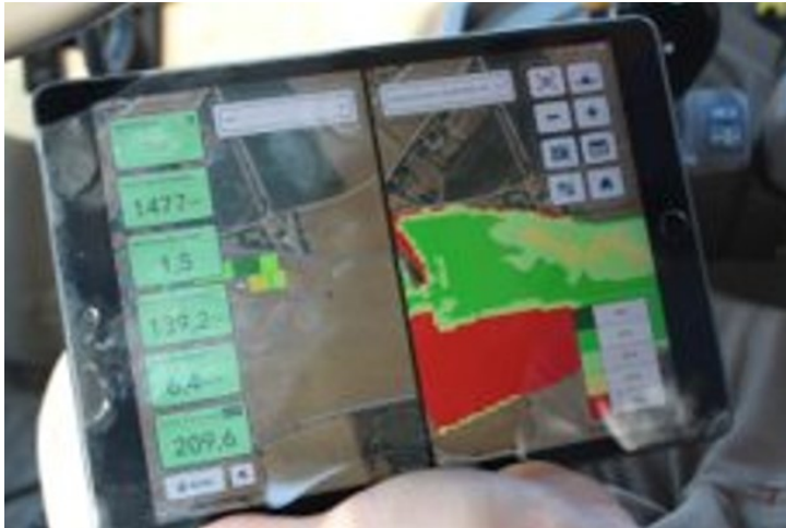
Figura 2. Pantalla del dispositiu instal·lat a la màquina per visualitzar el mapa de prescripció i les dosis a aplicar.
