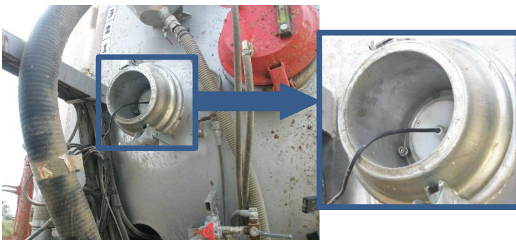
Detall de conductímetre instal·lat a la cisterna.
