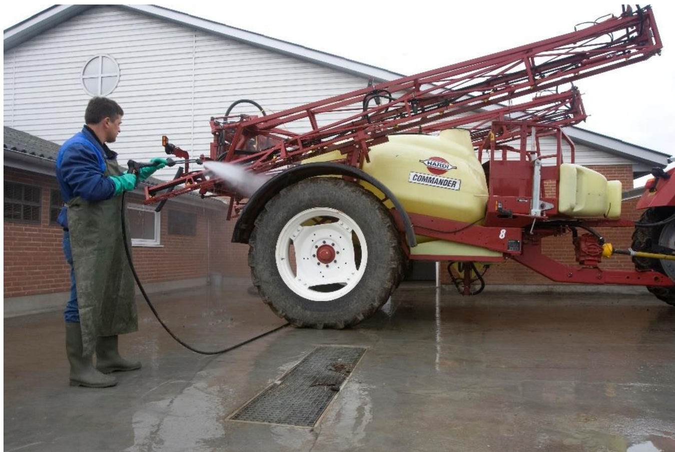
Figura 1 Neteja exterior del polvoritzador en una zona amb recollida de les aigües brutes (Font: projecte TOPPS).
