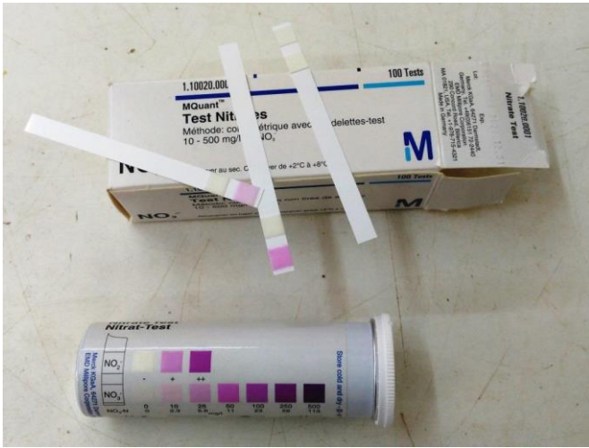
Fotografia 2. Tires colorimètriques de mesura del contingut de nitrats dissolts en aigua.
