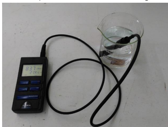
Fotografia 1. Conductímetre mesurant una mostra d'aigua.
