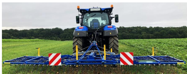
A dalt, tractor arrossegant una grada de pues flexibles amb dos cossos modulars i, a baix a la dreta, tractor arrossegant una grada de pues d'un sol cos i detall d'aquest model de grada.
