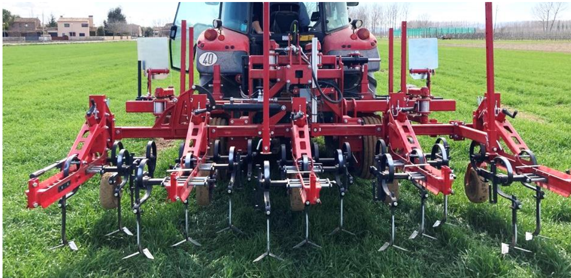
Binadora de precisió amb una càmera, preparada per treballar amb una separació de 25 cm entre les línies de sembra.
