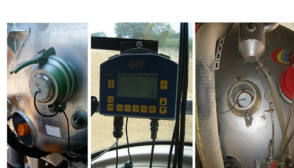
Figura 3. Conductímetre fix a la cisterna
