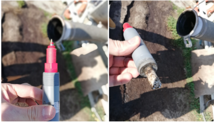
Figura 10. Neteja del sensor del conductímetre a la bassa
