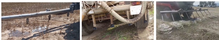
Figura 11. Diferents tipus de miniplats no permesos Què no és recomanable
