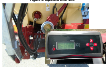
Figura 7. Equip conductímetre fix a la cisterna
